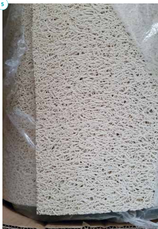
♦ AMORTYZUJĄCA MATA MONTOWANA POD FOLIĘ BASENOWĄ PVC, PRZYPOMINAJĄCA STRUKTURĄ MAKARON SPAGHETTI
