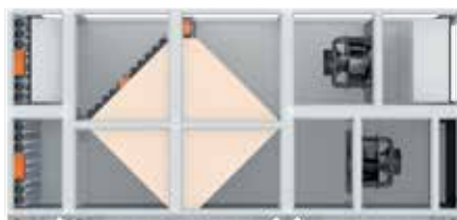
♦ CENTRALA BASENOWA TYPU DP CF POOL BASIC Z PRZECIWPRAĐOWYM WYMIENNIKIEM CIEPŁA I WENTYLATORAMI EC
