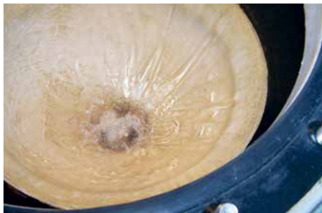
♦ LEJ PRZEWODOWY W DENNICY GÓRNEJ, NIE W CZĘŚCI WALCOWEJ
