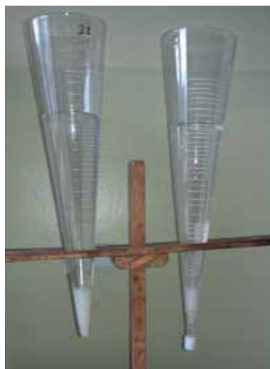
RYC. 2. SEDYMENTACJA ZAWIESIN W LEJU IMHOFFA
