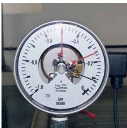
● POMIAR PODCIŚNIENIA W FILTRZE NAMYWANYM
