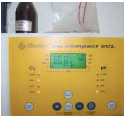
POMIAR PH, REDOX, CHLORU WOLNEGO I ZWIĄZANEGO
